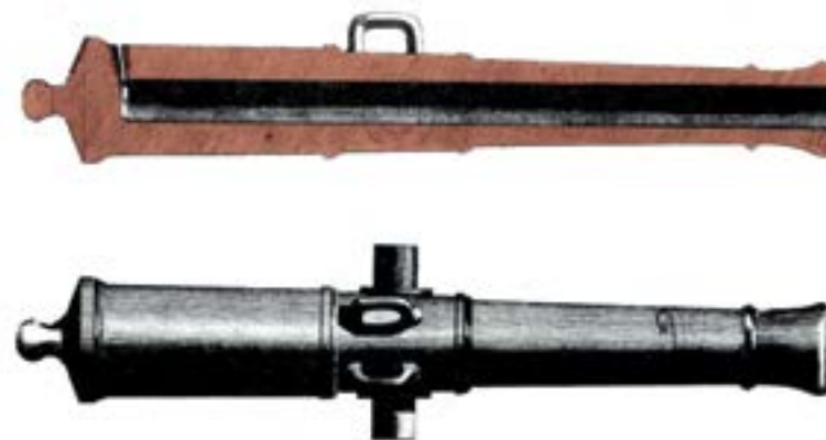
Canhão francês Gribbeauval com desenho simplificado sem ornamentações barrocas – Tratado de Heinrich O. Schell's de 1800
