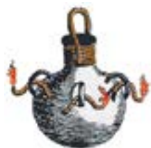
“São panelas de barro, com suas asas, cheias de pólvora fina, com uma granada carregada dentro. Se cobre com pele de carneiro e nas asas se colocam morrões acesos ou estopim”. Desenho do “Exame de Artilheiros” de Alpoim – 1744
