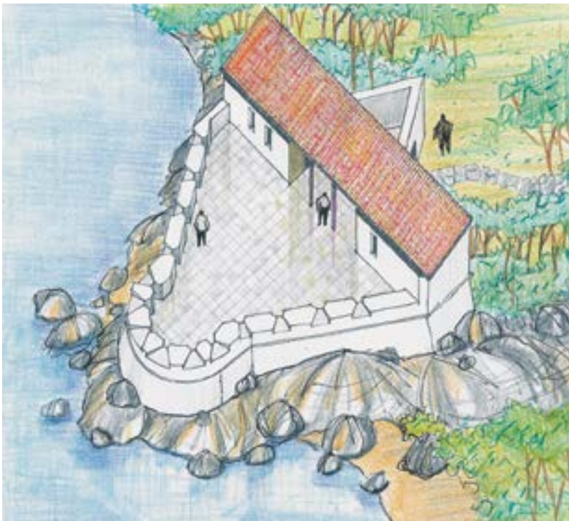
Perspectiva do projeto de Silva Paes para o Forte de Itapema em 1738. O formato de um baluarte único com o encontro das faces em semicírculo, derivou do reaproveitamento da bateria quinhentista. Na segunda metade do século, o edifício do quartel já aparece no centro do terraplano com duas guaritas nos encontros das faces com os flancos. VHM
